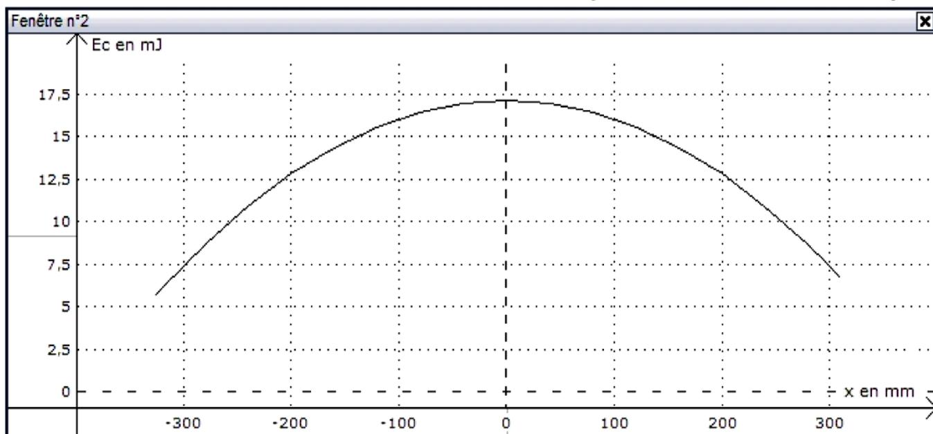
**Variation de l'énergie cinétique du pendule en fonction de l'abscisse x du centre d'inertie G**
